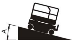
Максимальный продольный уклон в сложенном положении
